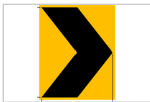
「輔2」安全方向導引標誌
